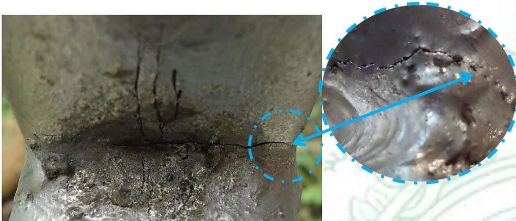
**Figura 25. Agrietamiento producto de ensayo de flexión**
