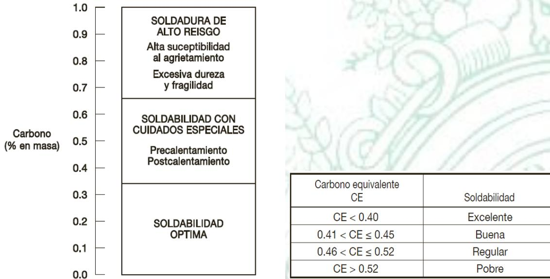
**Figura 4. Efecto del carbono en la Soldabilidad del acero [17]**
