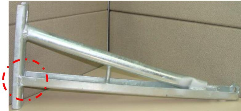
**Figura 20. Junta Soldada para análisis macroscópico y microscópico.**
