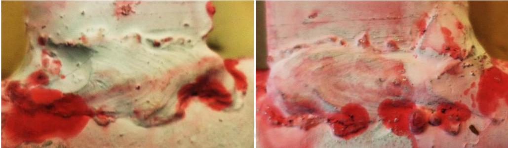
**Figura 19. Ensayo de líquidos penetrantes en la soldadura de la base con el cuerpo de la ménsula de 44 kV**
