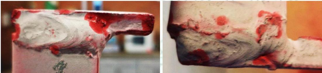
**Figura 18. Ensayo de líquidos penetrantes en soldadura en tapa de agarre**
