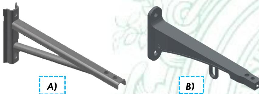
Figura 9. Diseños ménsulas de 44 kV. A) Perfilería en acero estructural NTC 1920-NTC 1985 C) Fundición nodular.
