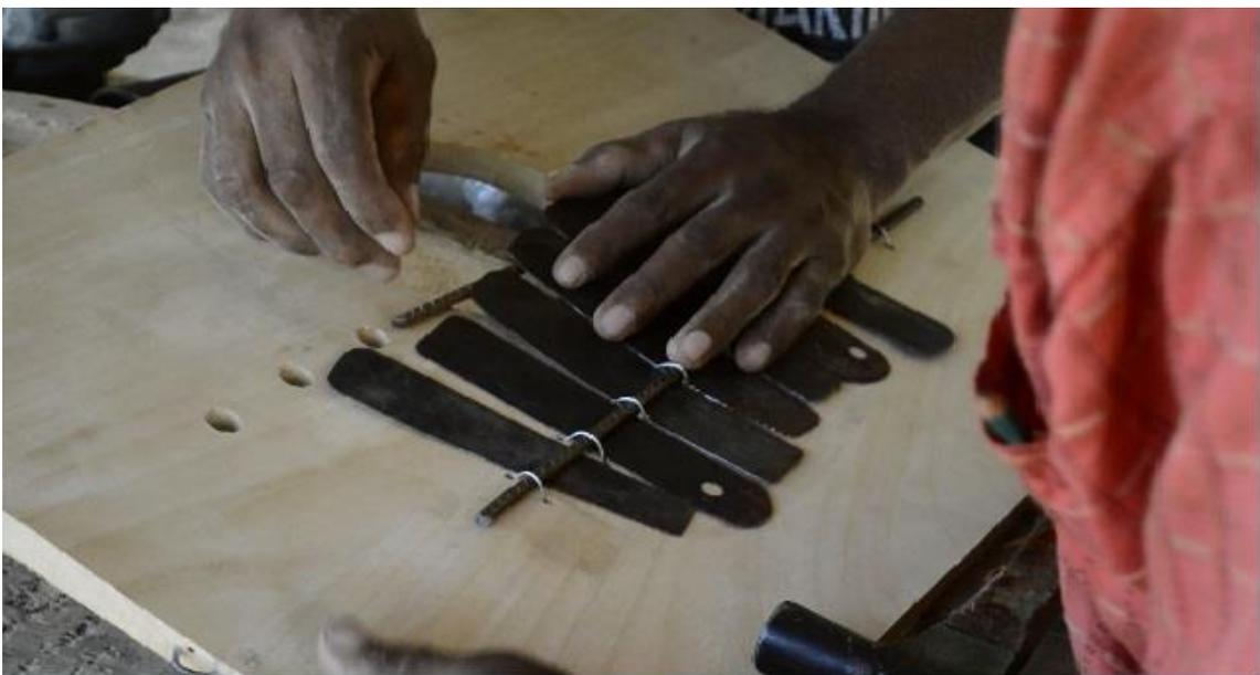
Foto 25. Los flejes deben quedar elevados por lo cual colocan otra varilla de hierro debajo de éstos en la parte superior.
