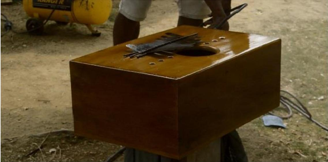
Foto 30. A la marímbula le dan mínimo tres capas de pintura entre las cuales revisan y lijan las partes que lo requieran.
