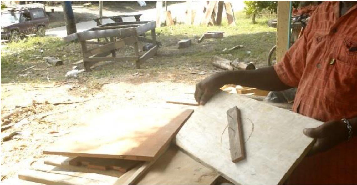
Foto 16. Por ejemplo, para hacer el orificio central, toman un trozo de madera (que hará la función de compás) el cual es clavado en el centro de la tabla que servirá de parte frontal de la marímbula y con él dibujan una circunferencia, que se convertirá en la boca del instrumento.
