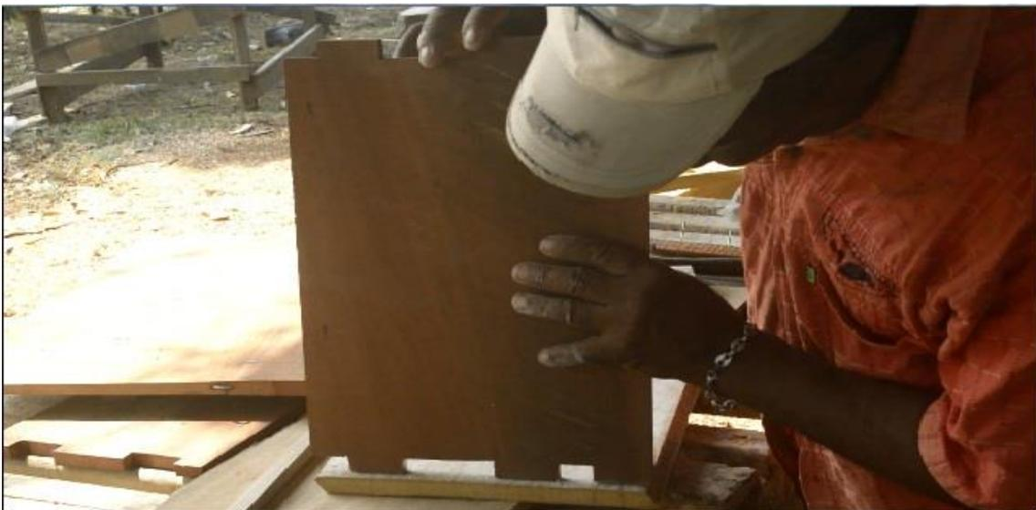
Foto 17. Se toma una plantilla para dibujar el modelo de intersección y luego ensamblar.
