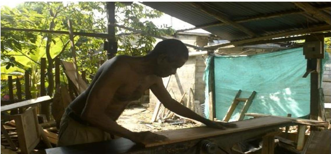
Foto13. Luego del secado, comienzan a pulir cada trozo de madera para obtener una superficie más lisa.
