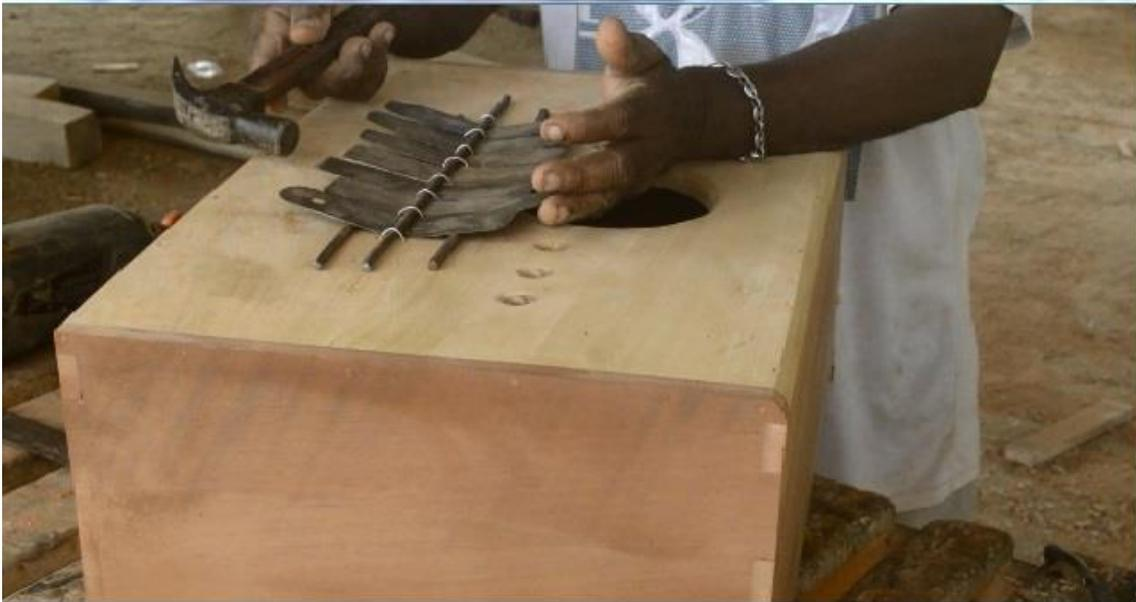
Foto 28. Se pone la tercera barra de hierro debajo de los flejes en la parte inferior logrando que estos queden cóncavos. A continuación con el martillo se ubican de forma definitiva cada uno de los flejes.
