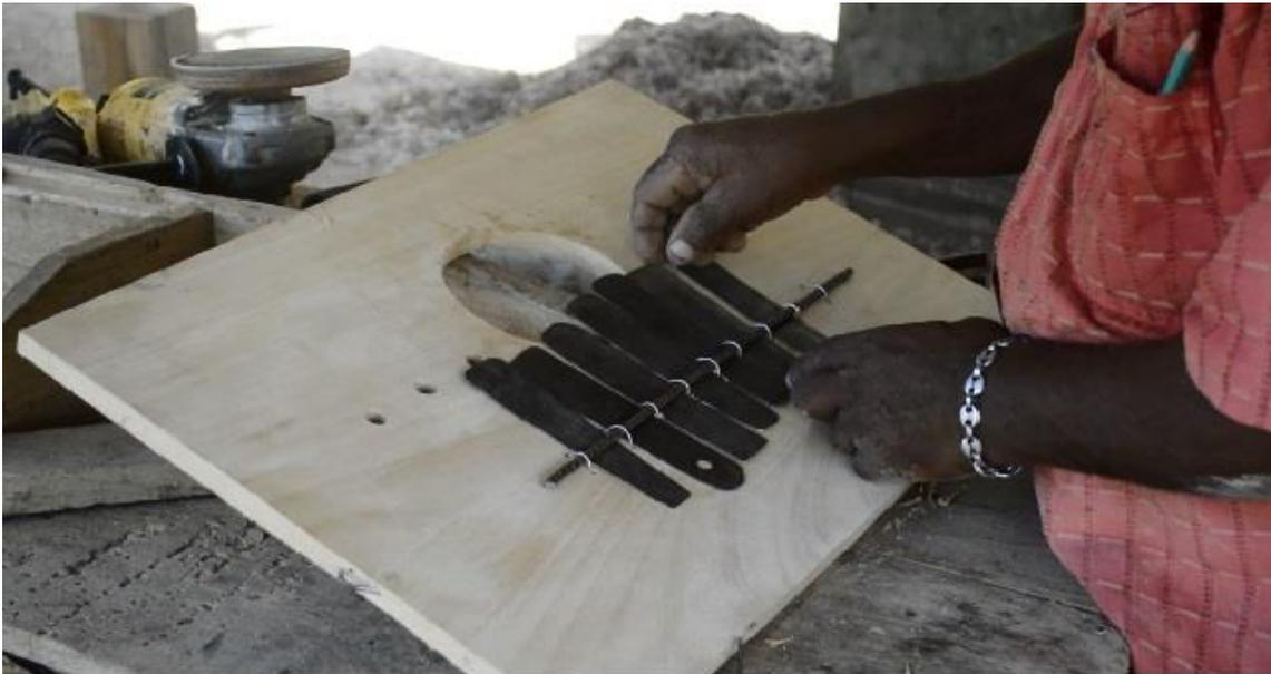
Foto 24. Como los flejes no deben quedar a la misma distancia de la barra, él los posiciona en el sitio indicado.
