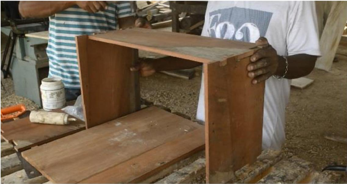
Foto 26. Después de haber puesto y recortado las medidas de las intersecciones de cada tabla se empieza a empalmar, primero se usa pegante de madera y se refuerza con putillas pequeñas.
