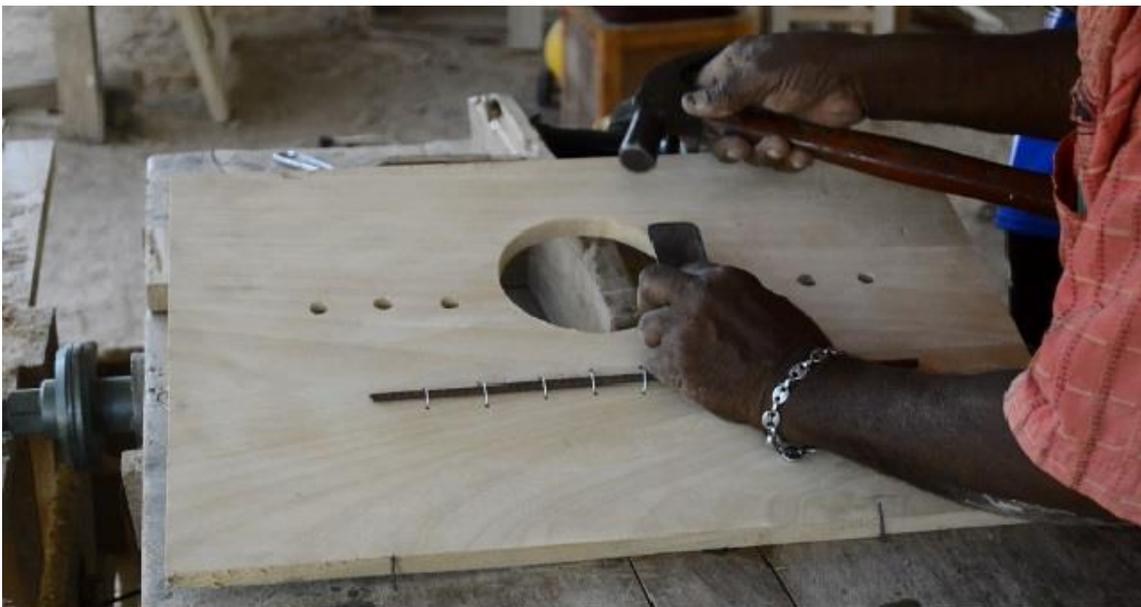
Foto 23. Después de haber montado la barra central, con un martillo fijan cada uno de los flejes.
