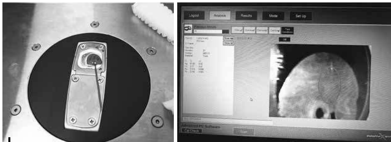
Figuras 2 y 3 – Análisis de uno de los tupus de plata posicionado en el stand del analizador (izquierda). Se puede elegir la región de análisis a través de la imagen dada por la cámara del analizador (derecha).
