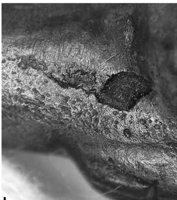
Figura 10 – Detalle de la falta de metal en las piernas de la estatuilla femenina en plata ME I 281 elaborada por vaciado
