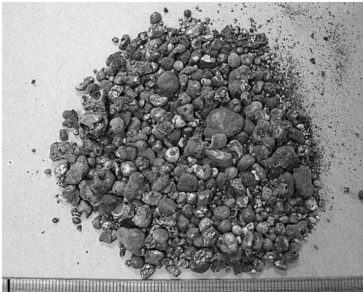
Figura 5 – Porciones de cobre obtenidas tras machacar la escoria en un experimento de correducción de mineral de cobre y casiterita
